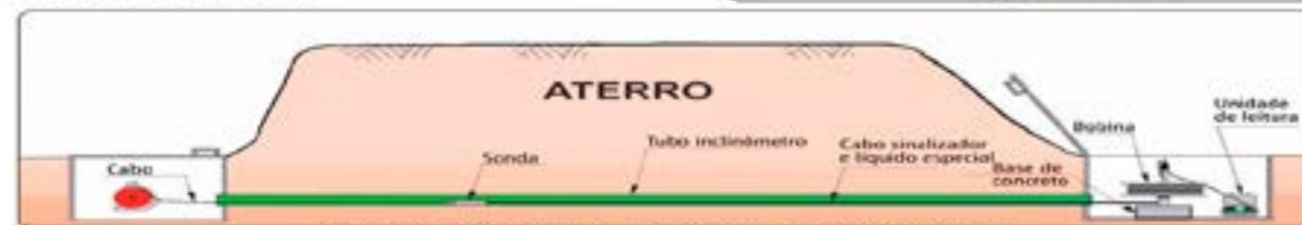
Instalação do medidor do perfil de recalques
