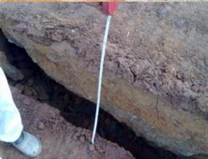
Figura 1 - Rutura de um aterro lançado sobre solo mole, com objetivo de ampliar uma rodovia, sem melhoramento do solo mole prévio. No detalhe as placas de aterro deslocadas.
