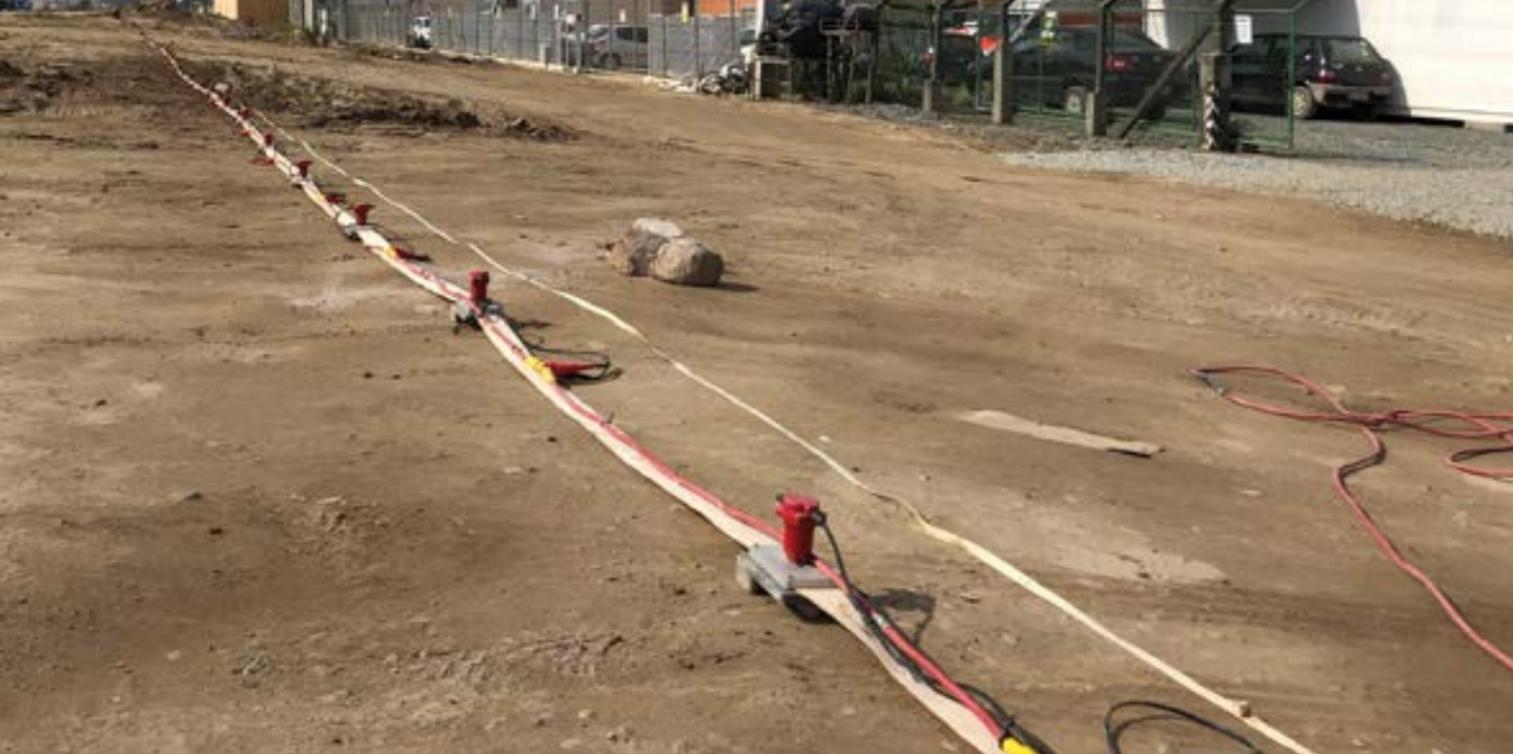
Figura 1 - A certificação do melhoramento do solo com geoenrijecimento é feito com tomografia do solo por imagem (TSI).
