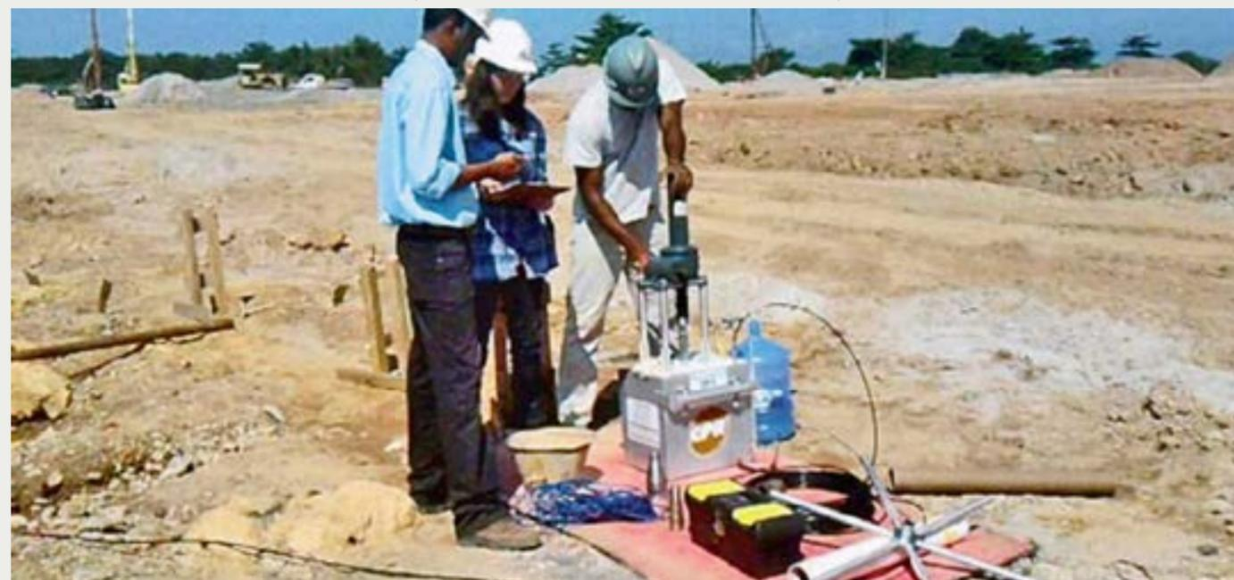
Figura 7 - Análise pressiométrica do geoenrijecimento: A expansão da sonda no solo equivale ao processo de melhoramento do solo com geoenrijecimento, que é por expansão de cavidades.
