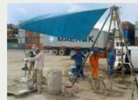
Figura 20 - Análise pressiométrica executada na área pavimentada da Zona Portuária.
