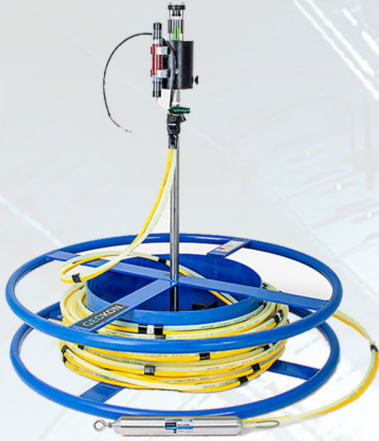
SENSORES DE RECALQUE
