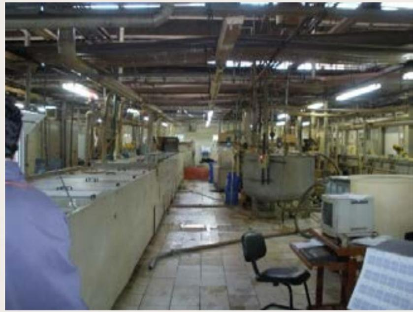
Figura 6: Equipamentos extensos exigiam o renivelamento constante, devido ao recalque crescente do piso.
