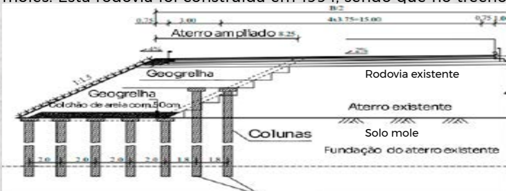
Figura 3 - Projeto, com corte na rodovia ampliada.
