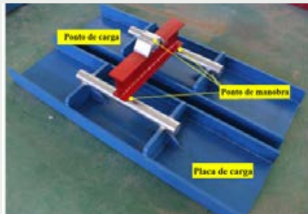
Figura 4: Dispositivo simulador do carregamento na estrada.
