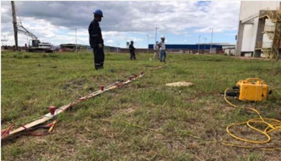
Figura 5: Monitoramento do melhoramento do solo mole, com tomografia do solo por imagem (TSI), de modo a levantar os parâmetros de resistência e rigidez, antes do início dos serviços, para ampliação de empreendimento logístico.
