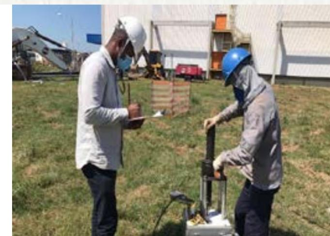
Figura 4: Análise prévia da resistência e rigidez do solo de fundação, com presença de camadas de solos moles, utilizando-se pressiómetro, para início do melhoramento com geoenrijecimento.
