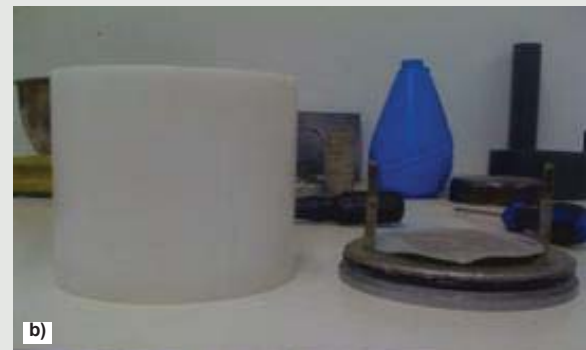
Figura 12 - Material utilizado para a realização dos ensaios edométricos: a) base circular; b) perspectiva da base circular da célula edométrica.
