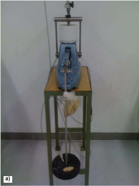
Figura 15 - Carregamento dos ensaio edométricos: a) edômetro com braço de carga; b) edômetro de carga direta.
