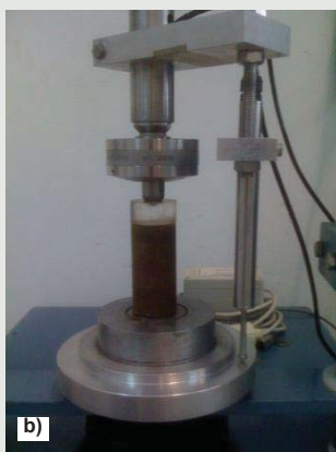
Figura 4 - Ensaios UCS: a) prensa Wykeman Farrance LTD tristar 5000Kg; b) corpo de prova para o ensaio UCS; c) corpo de prova após o fim do ensaio.
