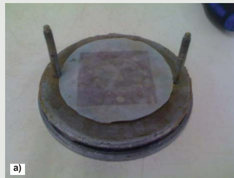
Figura 12 - Material utilizado para a realização dos ensaios edométricos: a) base circular; b) perspectiva da base circular da célula edométrica.
