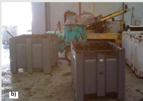
Figura 3 - Homogeneização do solo: a) mistura manual, com o auxílio de colher de pedreiro; b) mistura mecânica do solo com a ajuda de uma betoneira (IMER Mix240).
