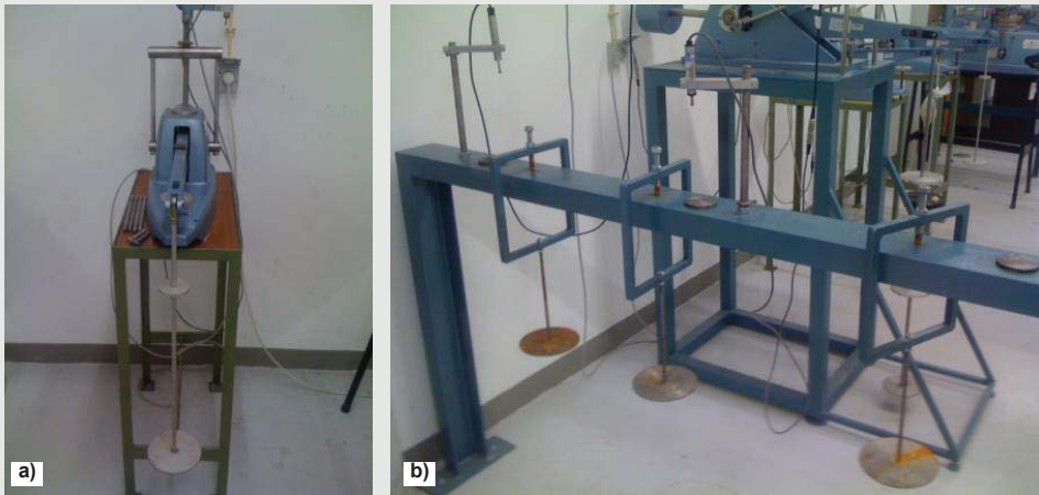
Figura 11 - Edômetros utilizados: a) edômetro com braço de carga; b) edômetro de carga direta.
