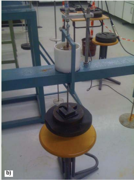
Figura 15 - Carregamento dos ensaio edométricos: a) edômetro com braço de carga; b) edômetro de carga direta.
