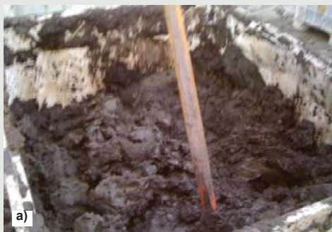
Figura 3 - Homogeneização do solo: a) mistura manual, com o auxílio de colher de pedreiro; b) mistura mecânica do solo com a ajuda de uma betoneira (IMER Mix240).
