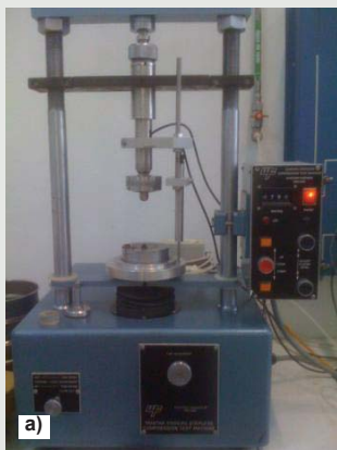
Figura 4 - Ensaios UCS: a) prensa Wykeman Farrance LTD tristar 5000Kg; b) corpo de prova para o ensaio UCS; c) corpo de prova após o fim do ensaio.
