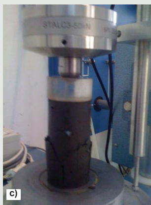
Figura 4 - Ensaios UCS: a) prensa Wykeman Farrance LTD tristar 5000Kg; b) corpo de prova para o ensaio UCS; c) corpo de prova após o fim do ensaio.
