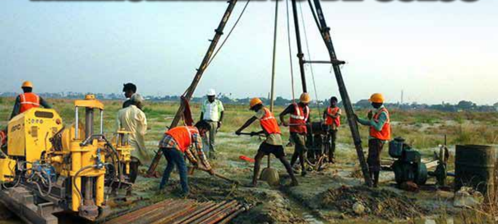
Figura 1 - Ensaios tradicionais SPT, CPTu e Palheta não se relacionam com solos compósitos, pois caracterizam-se pela rutura do solo. É essencial trabalhar apenas com ensaio que se caracterizam por deformação.
