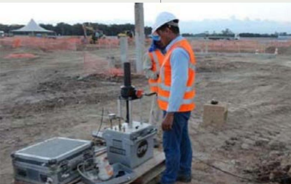
Figura 9 - Procedimento executivo de ensaio pressiométrico
