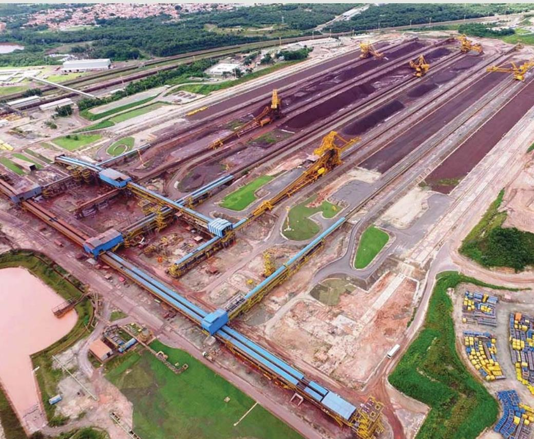
Figura 6 - O S11D, maior projeto de mineração da Vale em termos de custo, volume e qualidade, localizado em Canaã dos Carajás, irá inovar ao usar a tecnologia que reduz a quase zero o uso de recursos hídricos. O processamento de minério de ferro ocorrerá a partir da umidade natural sem o uso de água do processo convencional, diminuindo os impactos ambientais.
