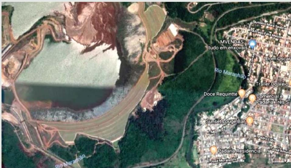
Figura 3 - Barragem de Congonhas em Minas Gerais, tem cerca de 76 metros de altura e capacidade de 50 milhões de metros cúbicos de rejeitos.
