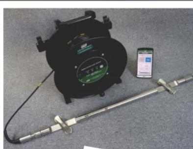
Este outro inclinômetro é equipado com sensor de inclinação para taludes de até 45°, informando sua inclinação, assim como em paredes de contenção, barragens, etc. Opera com bluetooth e smart phase.
